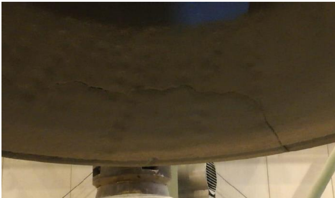
2.3 Сурет - Ұсақтау камерасында ұсақталмайтын зат түскен кездегі тостаған қаптамасының (ТҚ) бетінде пайда болған деформация
