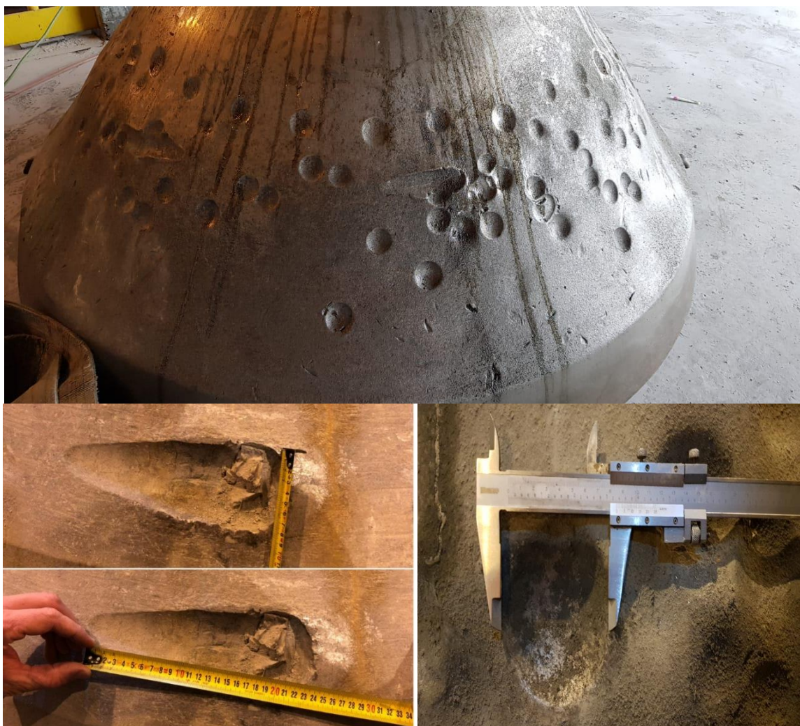
2.1 Сурет - Ұсақтау камерасында ұсақталмайтын затты сынаған кезде КҚ-ның деформациялануы
